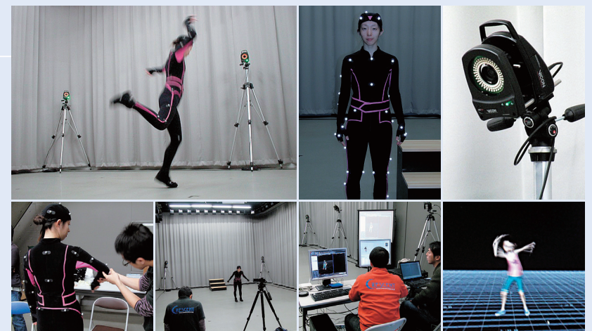
モーションキャプチャーでは人体の各所にマーキング用の印を貼り、複数の赤外線カメラで人の動作を撮影する。映像身体学科ではダンスやスポーツ競技などを撮影して動作解析をしたり、合成用のCG画像を作り出したりしている
