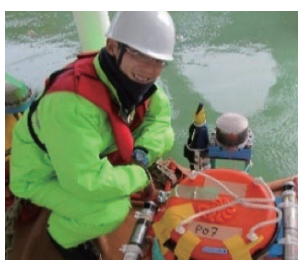
海底圧力計を用いた津波観測
