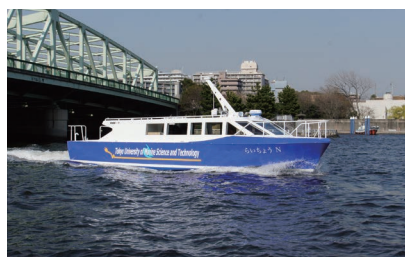
低環境負荷海上輸送システムの開発(写真は電池推進船「らいちょうN」)
