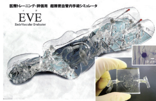
医療トレーニング・評価用超精密血管内手術シミュレータ および円形断面を有する毛細血管モデル。最小径の直径は10 micron。 EVE: Endo Vascular Evaluator and capillary blood vessel having circular cross section.
