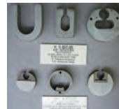
本多光太郎が発明した KS鋼・新KS鋼 (金属材料研究所)
