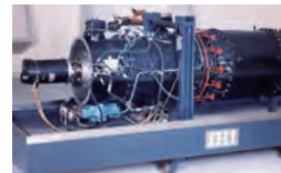
沼知福三郎が発明したジェットエンジン 「ネ20」(流体科学研究所)
