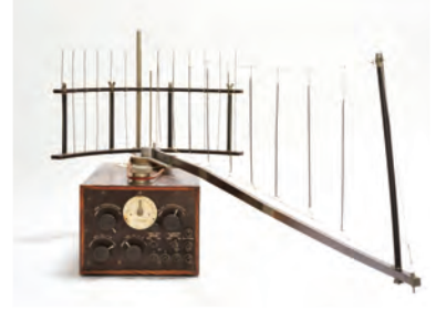
八木秀次・宇田新太郎が発明した 八木・宇田アンテナ(電気通信研究所)
